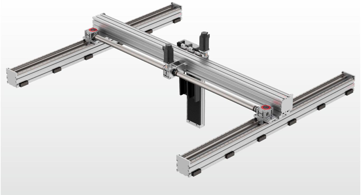
Diese Applikation besteht aus zwei X-Achsen mit Zahnstangentrieb und 2270 mm Hub als Basis sowie einem Portal mit 2610 mm Hub, ebenfalls mit Zahnstangentrieb. Für den zentralen Antrieb der X-Achsen mit einem Motor werden Verbindungswellen mit Metallbalgkupplungen eingesetzt, was für eine absolut spielfreie Drehmomentübertragung und exakte Positionierung des Portals sorgt, selbst bei hochdynamischen Bewegungen.
