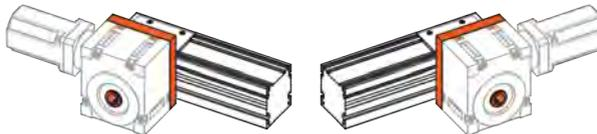
Getriebemontage H - Getriebe nach vorne und oben:
