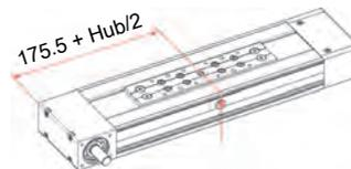
Schmierstelle des Schlittens fluchtend auf Schmiernippel am Grundprofil ausrichten.
